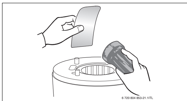
Fig. 52 Controllo della presenza di residui nello scambiatore primario
